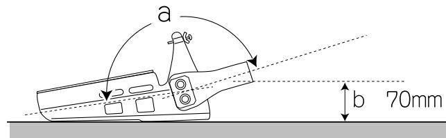
(出荷時寸法bは 70mm でストライクになるように調整されています。)
