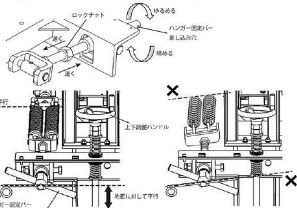
\* ハンガー固定バーを使用して、スプリングは必ず水平となる様に固定してください。スプリングが斜めの状態で使用されますと、短期折損やその他の部品の変形、損傷の原因となります。
