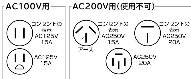
コンセントの表示又は型式により電圧を自己判断するのは危険です。必ずしもコンセントの形状に合った電圧がきているとは限りません。テスターにより、電圧を実測してください。
