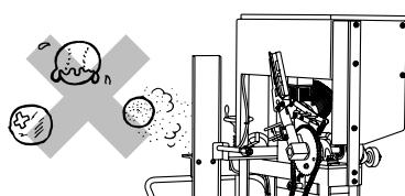
**!** 革や糸が切れているボール、変形しているボールなど、傷みのひどいボールは使用しないでください。ボールがスリップして予想外の方向に飛ぶ恐れがあり大変危険です。
