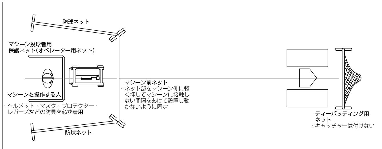
①マシーンを使用位置に移動させマシーンを設置し、本体固定ハンドルでマシーンを固定します。
