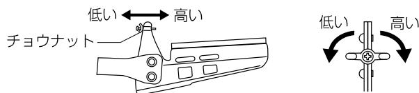
チョウナットをゆるめ、ネジを左に回すと、投球が低めになります。調整したあとは必ず、チョウナットを締めて固定してください。右に回すと高めになります。
