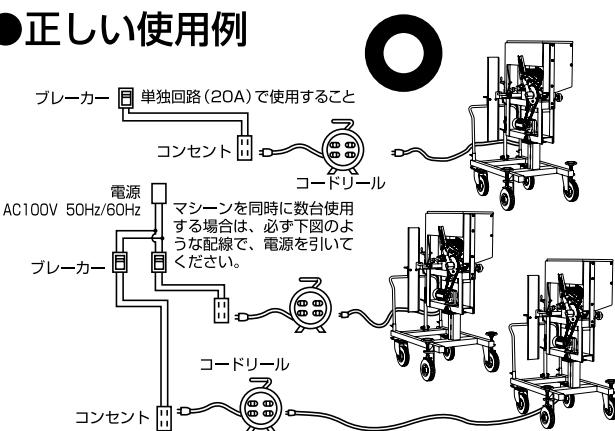
注) **20A(アンペア)以下** のブレーカーを使用すると、マシーンの電源スイッチを入れ、速度を上げる途中でブレーカーが落ちる場合があります。(容量不足)
