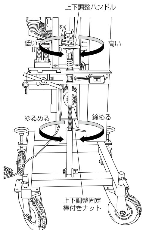
⑩調整が終われば上下調整固定棒付ナットがきっちり締まっているか確認してください。
