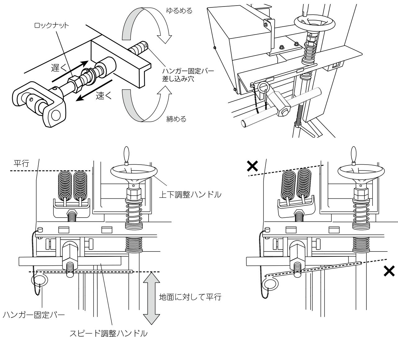
※ ハンガー固定バーを使用して、スプリングは必ず水平となる様に固定してください。
