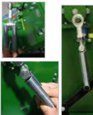
※ カムフランジのブレーキ接触部分以外にブレーキシューがカムフランジに接触している場合、(ハンドに抵抗が有る場合)には、ブレーキ調整ナットの締めすぎ(ブレーキの効かせ過ぎ)となり、この状態で投球すると、常にブレーキが効いている状態となり投球飛距離が低下しますのでご注意ください。
