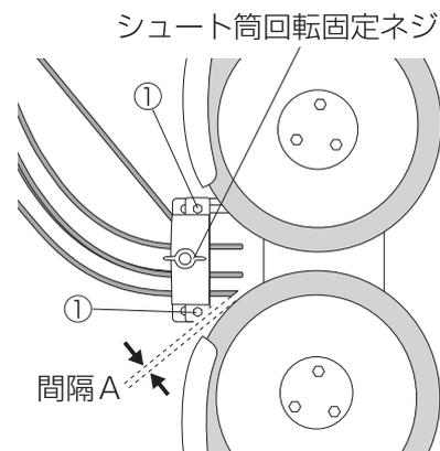
**⚠ 危険** 剥離、劣化しているホイールを高速回転させると、遠心方向にふくらみ、シュート筒に接触する恐れがあります。ホイールの損傷にもつながり大変危険です。
