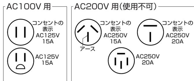
コンセントの表示又は型式により電圧を自己判断するのは危険です。必ずしもコンセントの形状に合った電圧がきているとは限りません。テスターにより、電圧を実測してください。
