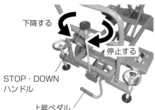
⑤使用する投げ出し高さに調整します。昇降台の STOP・DOWN ハンドルを時計回りに回して固定し、上昇用ペダルを踏み込むと本体は上昇します。STOP・DOWN ハンドルを反時計回りに回すと、本体は下降します。下降中に STOP・DOWN ハンドルを時計回りに回すと、下降が停止します。【図-5】
