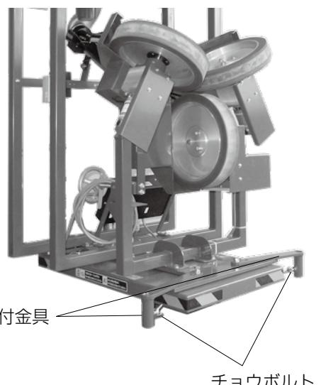
②フレーム取付金具を取り付けているボルトをスパナで反時計回りに回して取り外します。
