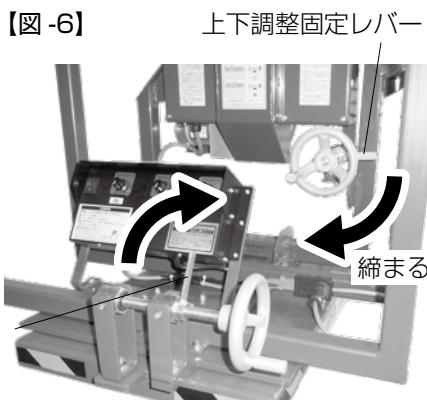
⑥上下調整固定レバー、左右調整固定レバーが締まっていることを確認します。緩んでいる場合は、時計回りに回して締めます。
