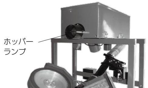
⑰マシーンの使用を終了するときは、ホッパー電源スイッチをOFFにし、投球ダイヤルを反時計回りに回して、数値を「0」に戻します。
