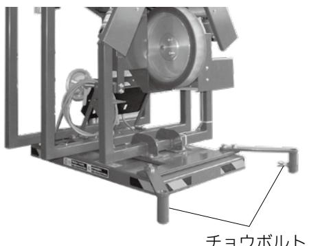
②ホイールを取り付けているボルトをメガネレンチで反時計回りに回して取り外します。【図-21】
