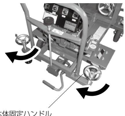
②マシーンを使用位置に移動させ、マシーンを固定します。
