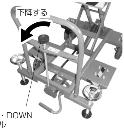
【23】昇降台が上昇している場合は、STOP・DOWNハンドルを反時計回りに回して最下部まで下降させます。【図-16】
