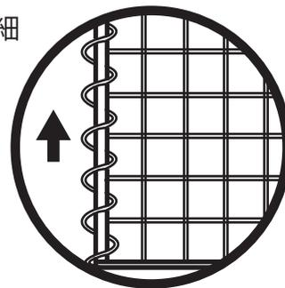
④図4.のように、ロープを巻きつけ固定します。
