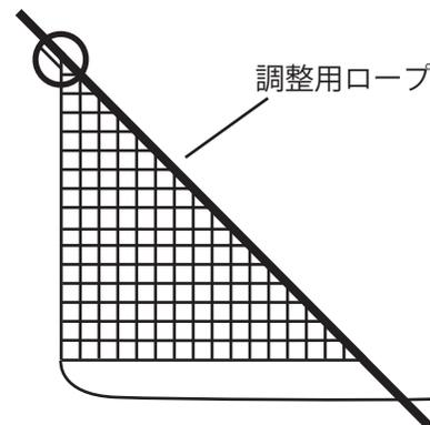
⑤図5.の投手用L型ネット上部パイプに調整用ロープを固定します。
