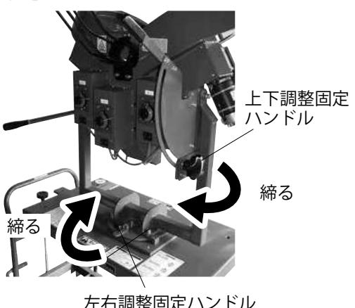
⑨バーニアダイヤルの数値が「0」、ホイールなどの回転部に接觸物がないことを確認し、電源スイッチを全てONにします。
