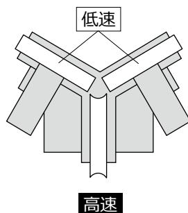
○飛び出し口を真上に向けた状態から、バーニアダイヤルの調整によって、フェアゾーンへのフライや、バックネット方向へのキャッチャーフライを設定できます。
