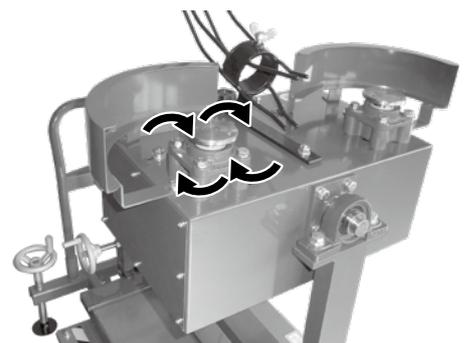
⑨ ⑦で取り外した2つのホイールをホイール軸にはめ込み、ホイールのボルトをメガネレンチで時計回りに回して締め付けます。
