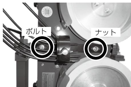
②シュート筒固定ネジを反時計回りに回して緩め、シュート筒が回転するようにします。【図-35】
