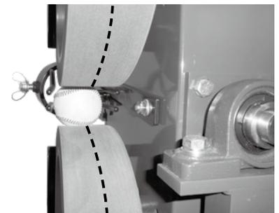
⑥本体角度調整固定ハンドルを操作し、マシン本体を左投手のストレート角度【図-33】にし、③～⑤の要領で作業します。
