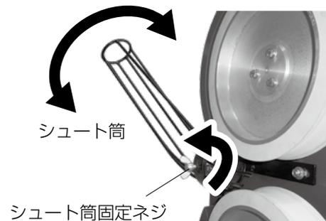
③シュート筒をどの角度で取り付けても、間隔【C】（ホイールとシュート筒先端の間隔）が 10mm 前後になるような位置まで、シュートホルダーをスライドさせます。【図-36】
