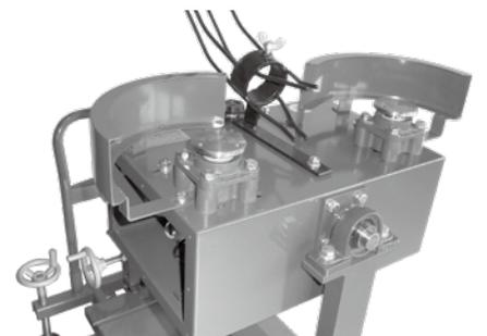
③テンションプーリーのボルトをメガネレンチ（10mm）で固定し、固定ナットをメガネレンチ（17mm）で反時計回りに回して緩めます。【図-39】
