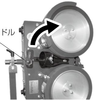
④ボールをシュート先に入れ、下側のシュート先端部2本と下側のホイールでボールが止まるように、シュート先端部をシュート調整棒で調整します。【図-31】
