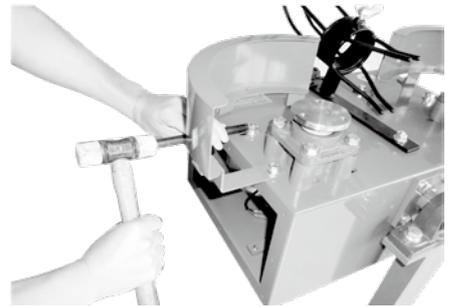
⑤調整が終わったら、テンションプーリー側のボルトをメガネレンチ（10mm）で固定し、固定ナットをメガネレンチ（17mm）で時計回りに回して締め付けます。
