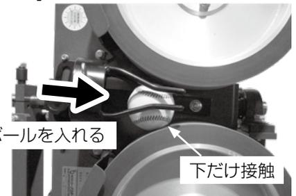
⑤ボールを少し押し上げ、ボールがホイールの中心位置に転がるように、シュート先端部をシュート調整棒で調整します。【図-32】
