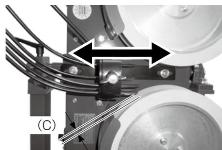
④①で緩めたボルト、ナットをメガネレンチで時計回りに回して締め付けます。
