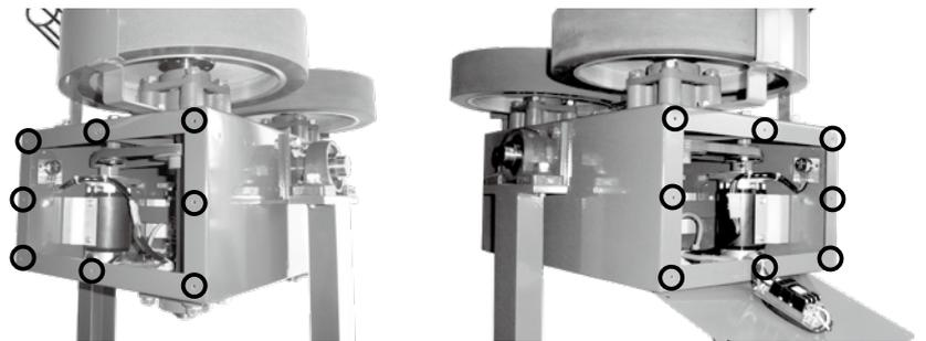
②ホイールを取り付けているボルトをメガネレンチ（13mm）で反時計回りに回して、ボルト、ホイールを取り外します。
