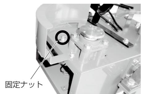
④固定ナットをプラスチックハンマーで軽くたたき、テンションプーリーをスライドさせて、ベルトを張ります。【図-40】
