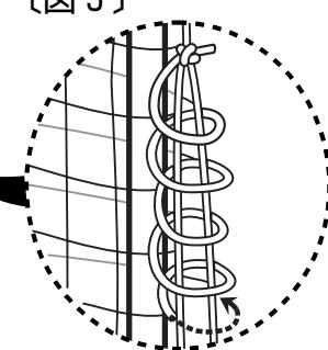
③ パイプフレームにかぶせたネットの[C]サイドパイプ(ストレート)側のスリット部分に取り付けられているロープで、ネットが外れないように縛って固定してください。[図5]
